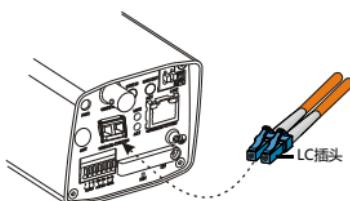
(4) 连接光纤插头和 EPON 光模块。
