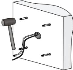
敲击膨胀螺栓，确认其固定在墙内无松动
