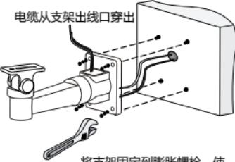
将支架固定到膨胀螺栓，使用平垫、弹垫和螺母锁紧
