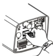
(3) 连接光纤插头和 SFP 光模块。
